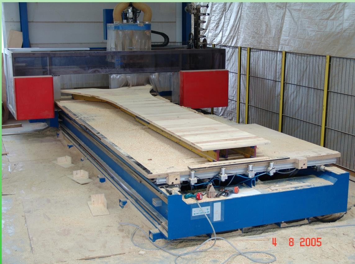
Fraisage du panneau coffrant latéral sur le Centre d'usinage CNC
